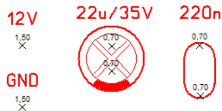
Рис. 108. Обозначение центров отверстий
